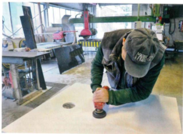
Als Notfalllösung stets einsatzbereit: Wenn das Bearbeitungszentrum mal ausfällt, kann Giorgos Kourtesis einen Parabolschliff auf einem Duschkboden auch mit der Handmaschine perfekt schleifen
