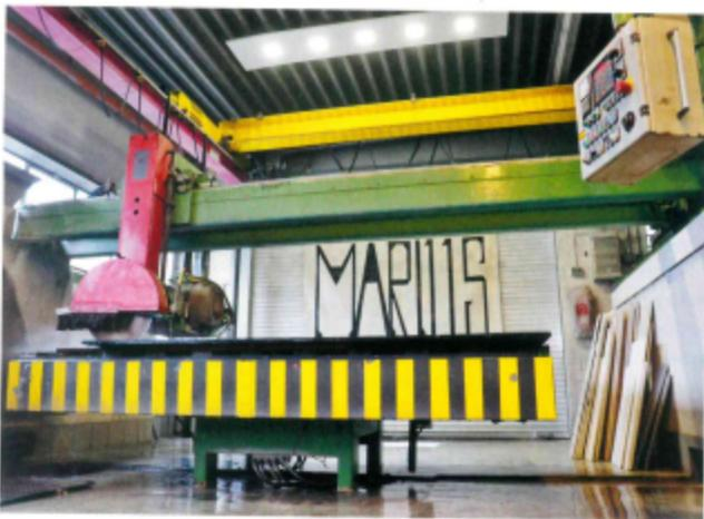
Nur für den rationellen Zuschnitt: Diese Drei-Achs-Brückensäge von Kolb übernimmt in der Werkstatt das Vorschneiden der Rohplatten und ist von daher schon wichtig, allerdings nur in Verbindung mit einem gut ausgebildeten Kopf an der Sägesteuerung
